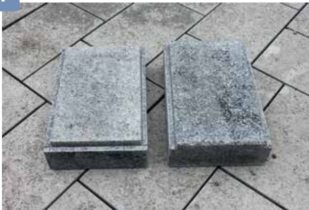
Je nach Verlegemuster sind alle vier Kanten der Unterseiten gefräst (Ellbogenverband)
