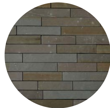
Grauwacke Stadtparkett mit geflammter Oberfläche. Kanten gesägt und abgezogen. Seitenflächen und Unterseite rilliert.
