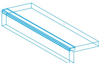
Winkelstufen mit Kontraststreifen aus Natursteinvorsatz mit sandgestrahlter Oberfläche.
