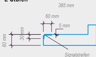
Die Stufen sind auch mit einem Signalstreifen aus Kaltplastik „nur“ am Auftritt erhältlich.
