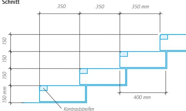
Die Auftrittsweite und Steigungshöhe können nach genauen, beidseitigen Maßangaben angefertigt werden.
