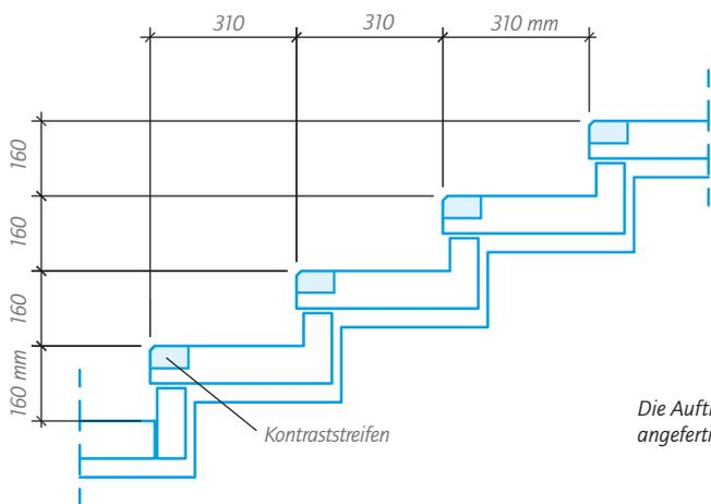
Die Auftrittsweite und Steigungshöhe können nach genauen, beidseitigen Maßangaben angefertigt werden.
