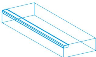
Blockstufen mit Kontraststreifen aus Natursteinvorsatz mit sandgestrahlter Oberfläche.
