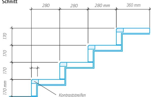
Die Auftrittsweite und Steigungshöhe können nach genauen, beidseitigen Maßangaben angefertigt werden.
