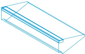
Keilstufen mit Kontraststreifen aus Natursteinvorsatz mit sandgestrahlter Oberfläche.
