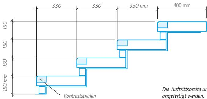
Die Auftrittsweite und Steigungshöhe können nach genauen, beidseitigen Maßangaben angefertigt werden.
