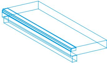
Legestufen mit Steller mit Kontraststreifen aus Natursteinvorsatz mit sandgestrahlter Oberfläche.
