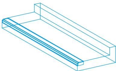
L Stufen mit Kontraststreifen aus Natursteinvorsatz mit sandgestrahlter Oberfläche.
