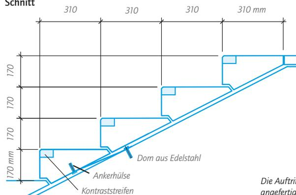
Die Auftrittsweite und Steigungshöhe können nach genauen, beidseitigen Maßangaben angefertigt werden.
