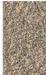
Viel verloren: Bis zu  $1,0 \text{ kg/m}^2$  Masse darf nach DIN EN 1338 Klasse 3 der Masseverlust im Mittel betragen.
