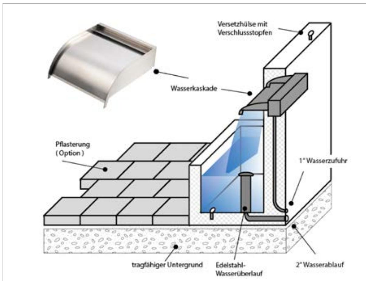
Der Wasserfall – Brunnen ist ein Fertigteil mit einem eingebauten Wasserfall (Kaskade), einem Wasserüberlauf (Standrohr), einer Wasserzuleitung für die Versorgung der Kaskade und einer Wasserableitung. Das Gewicht des Wasserfall - Brunnens beträgt, je nach Ausführung; ca. 1000 bis 1480 kg.
