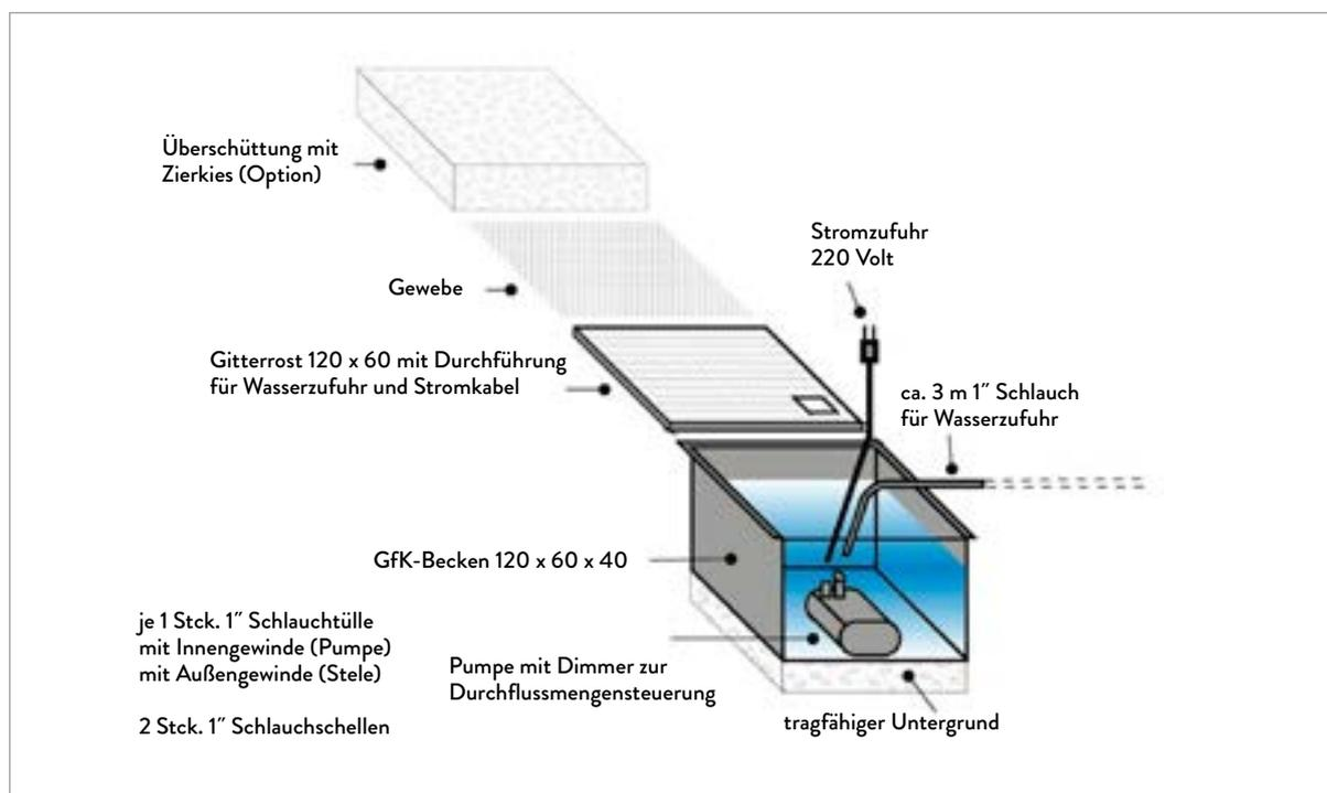
Das Zubehörset besteht aus einem GfK-Becken als Wasserreservoir, der dazugehörigen Gitterrostabdeckung, einem Filterfließ zur Abdeckung des Rostes und einem 3 m langen Wasserschlauch für den Wasserzulauf. Weiterhin wird ein Gebinde Pflegemittel „Birkenmeier – Brunnenklar“ mitgeliefert.
