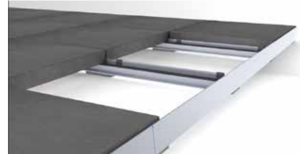
Randabschluss ohne Sockelblende und mit bündigem Abschluss (ohne Abschlusswinkel)
